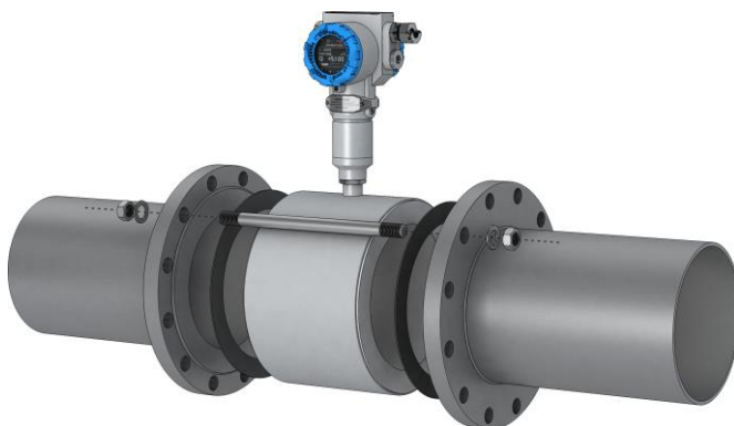
Рисунок 3.15 – Монтаж в трубопровод бесфланцевого («Сэндвич») расходомера
