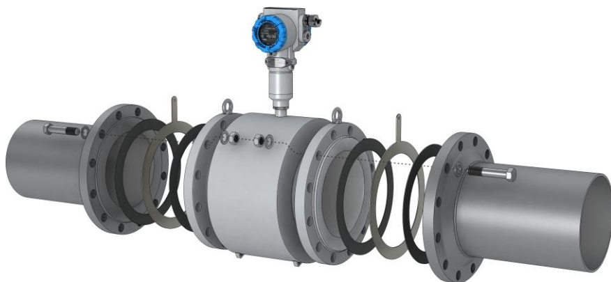
Рисунок 3.12 – Монтаж в трубопровод фланцевого расходомера с кольцами заземления 2
